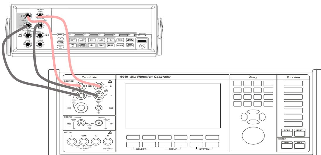
Obr. 27 Kalibrace měřidla výkonu
