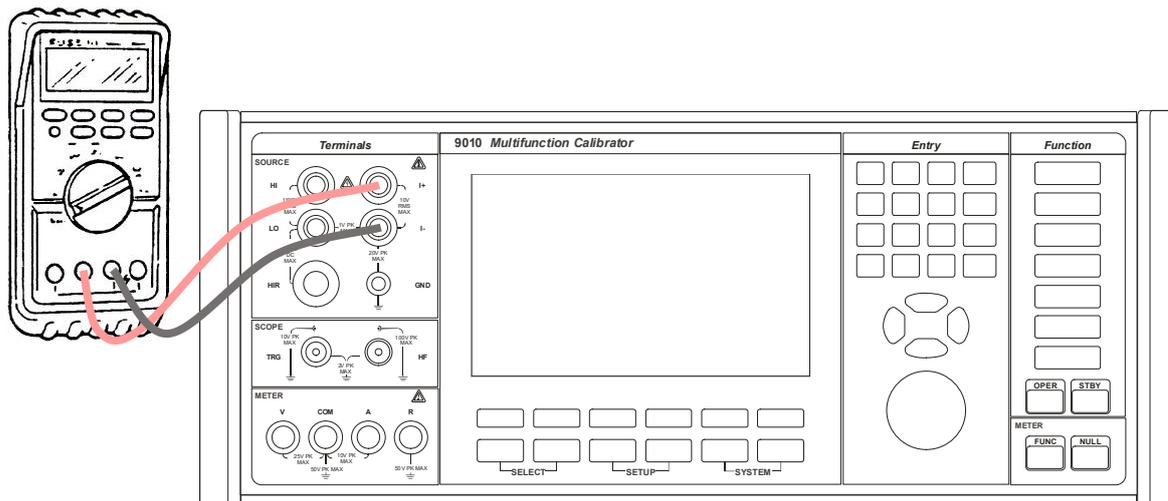
Obr. 20 Kalibrace ampérmetru
