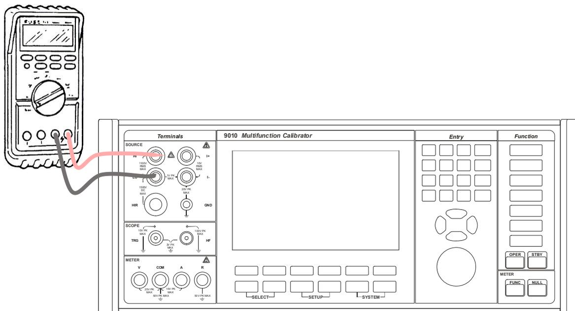
Obr. 15 Kalibrace voltmetru
