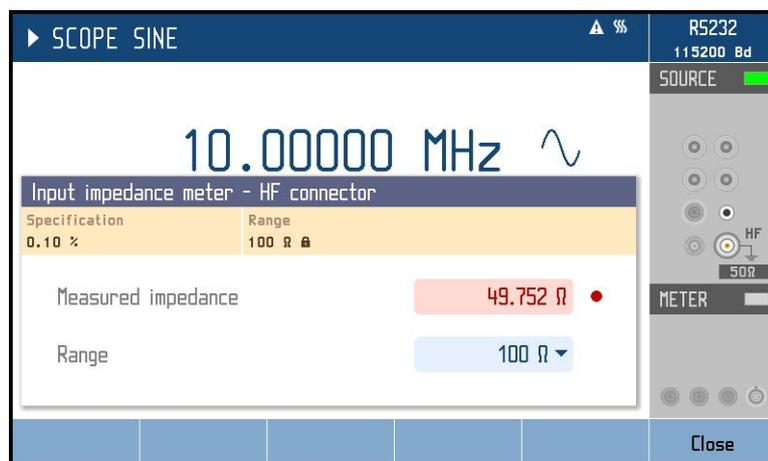
Obr. 37 Měření vstupní impedance - SCO option
