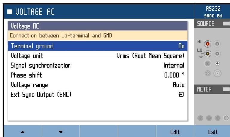
Obr. 19 Nastavení dalších funkcí napětí -Voltage SETUP
