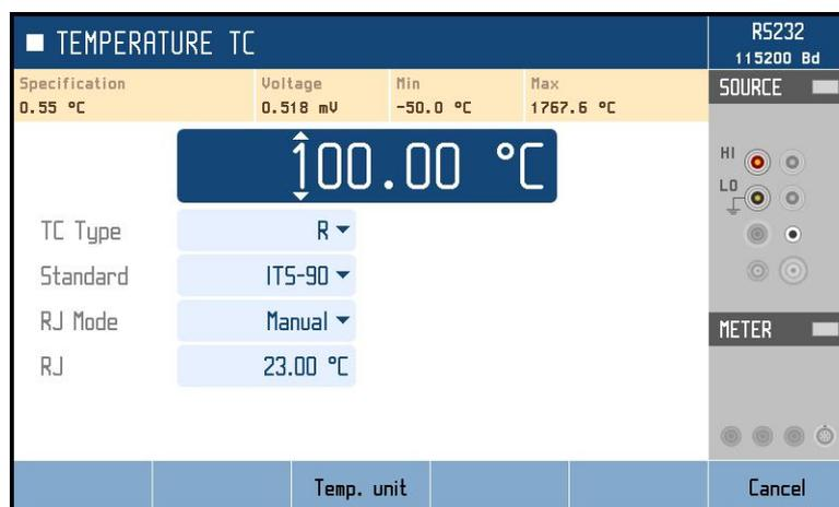
Obr. 40 Simulace termočlánků TC
