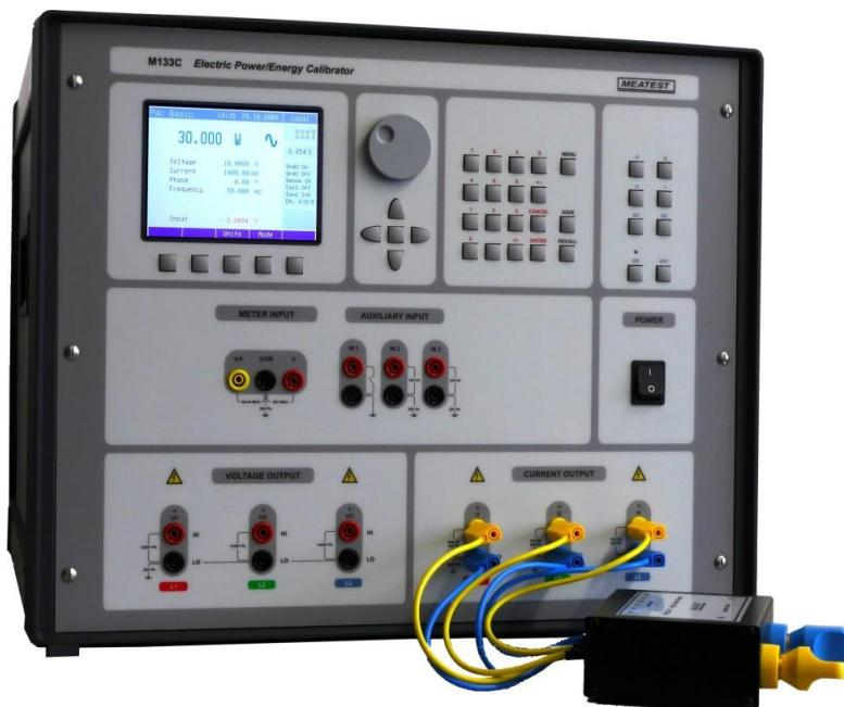
Standardní součástí dodávky je option M133C-01. S pomocí tohoto adaptéru lze paralelně spojit všechny proudové výstupy a tato konfigurace může dodávat v jednofázovém režimu až 90 A.
